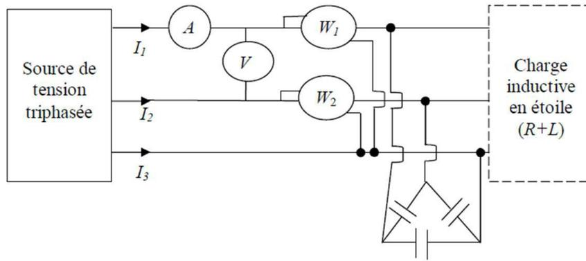
b. Pour une charge R, L donnée, complétez le tableau suivant en variant la charge C
