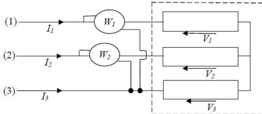
La bobine courant du 1<sup>er</sup> wattmètre est branchée sur la ligne(1), elle est donc traversée par le courant  $I_1$ . La bobine tension du même wattmètre est branchée entre les lignes (1) et (3), elle mesure donc la tension composée  $U_{13} = V_1 - V_3$ . L'indication du 1<sup>er</sup> wattmètre est donc :
