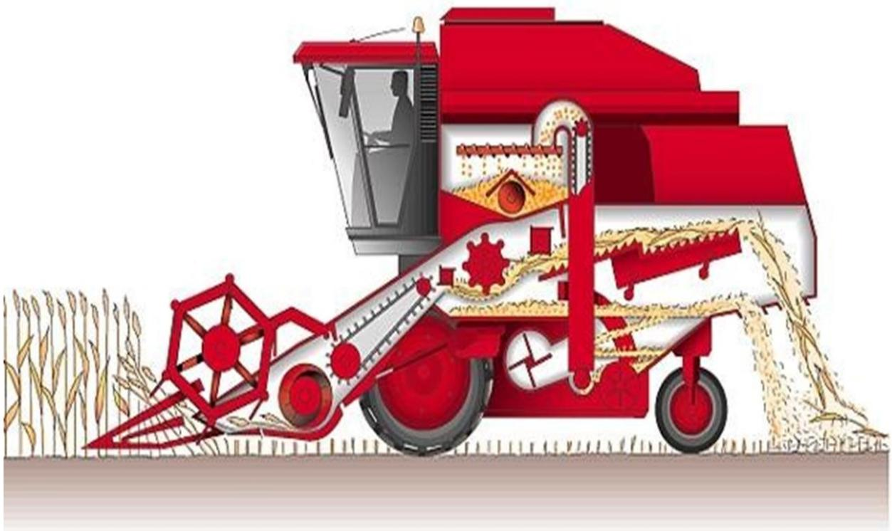
Figure 43 : Vue en coupe d'une moissonneuse batteuse. (CEMAGREF, 2012)
