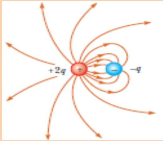
الشكل (10) : خطوط القوة الكهربائية لشحنتين نقطيتين  $+2q$  و  $-q$  ويظهر أن الخطوط الخارجة من  $+2q$  هي ضعف الخطوط الداخلة إلى  $-q$ .
