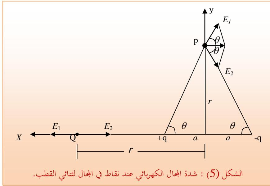
يكون مقدار المجال الكهربائي المحصّل E هو :
