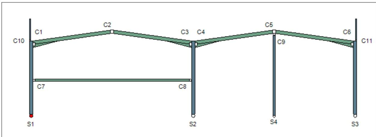
Un *appui* est noté par la lettre **S** suivie d'un numéro. La numérotation des appuis commence par les pieds de poteaux de gauche à droite (**S1** → **S3** dans l'exemple ci-dessus) puis les pieds de poteau intermédiaire de gauche à droite s'il y en a (**S4** dans l'exemple ci-dessus).
