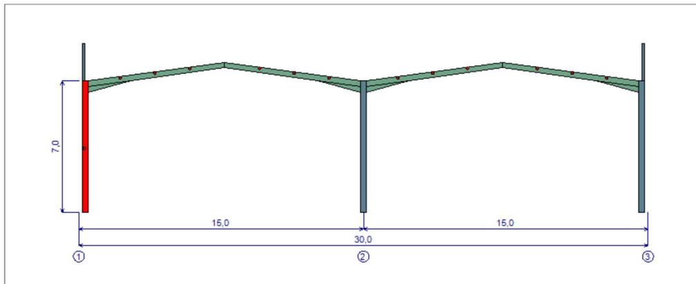
Un élément sur lequel on veut définir des maintiens latéraux intermédiaires peut être sélectionné dans la [liste des éléments](#) du portique choisi. L'élément sélectionné avec les maintiens intermédiaires est tracé dans le dessin situé en dessous de la [liste des éléments](#). Il est représenté en rouge sur le dessin du plan de portique. Dans l'exemple ci-dessus, le poteau de rive contenant un maintien intermédiaire est sélectionné.
