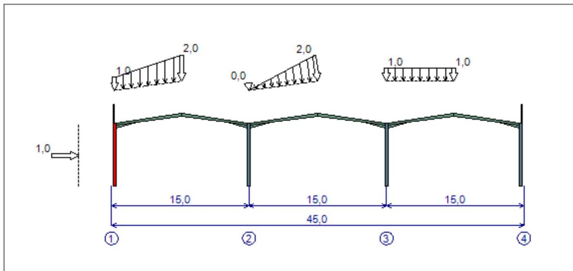
Un élément sur lequel on veut définir des charges concentrées et/ou des charges réparties peut être sélectionné dans la liste des éléments du portique. L'élément sélectionné est représenté en rouge sur le dessin du plan de portique. Dans l'exemple ci-dessus, le poteau de rive gauche est sélectionné.
