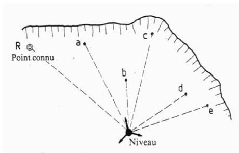
point connu en altitude ; on obtient la visée arrière (Lar).
