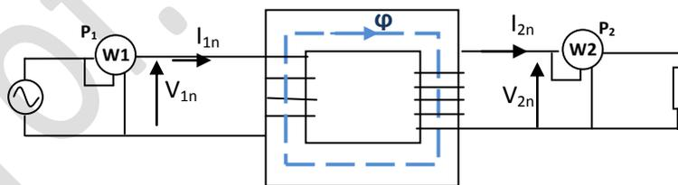
Fig .5.7. Evaluation du rendement par mesure directe
