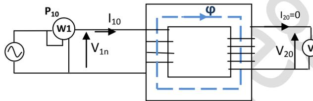
Fig. 5.8. Montage d'un essai à vide d'un transformateur
