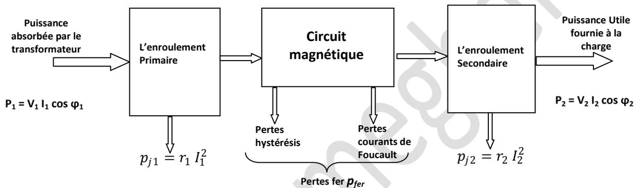
Fig.5.6. Bilan de puissance dans un transformateur réel
