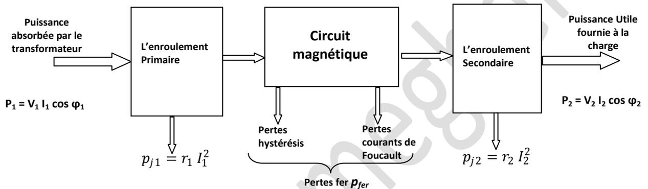
Fig.5.6. Bilan de puissance dans un transformateur réel
